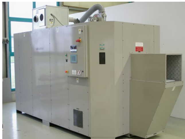
Eine speziell in die Produktion integrierte Anlage ermöglicht die Behandlung von Teilen mit variierenden Geometrien und ist gleichzeitig Inline-Verbindung zwischen einzelnen Produktionsinseln
