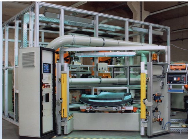
Anlage zur Behandlung von PP-Instrumententafeln bei einem OEM
