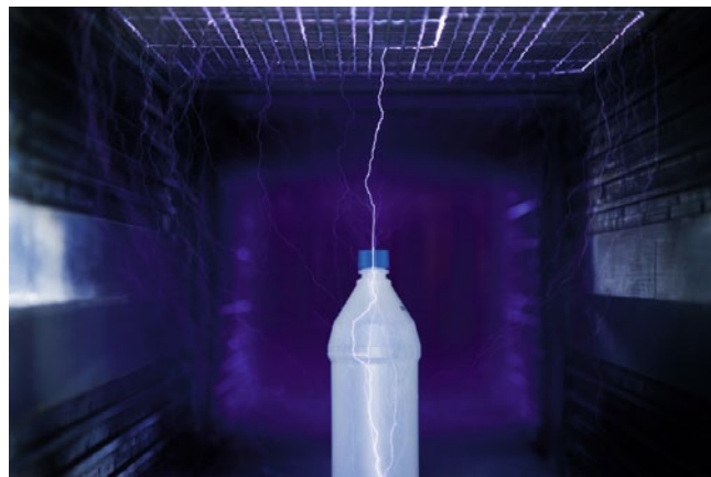
Innerhalb des Plasmatunnels wird ein atmosphärisches Plasma generiert, das eine dreidimensionale Behandlung aller Außenflächen ermöglicht
