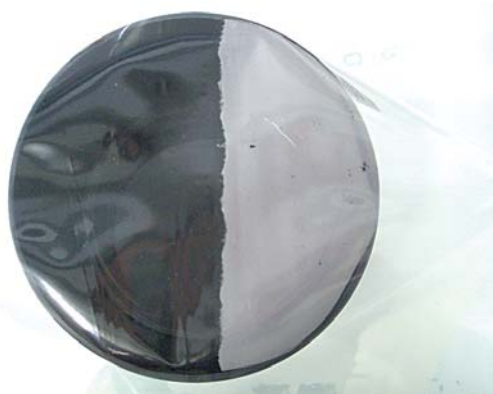
Abb.3: calvasol®ANTIFOG Effekt : Die Folie wurde auf der linken Seite funktionalisiert.
